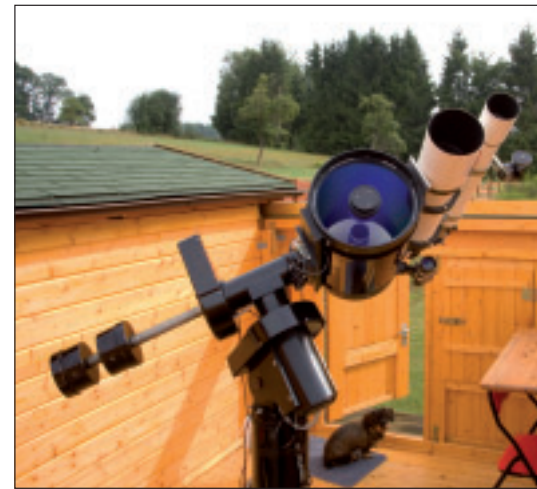
Abb. 2: Die Sternwarte von Bernd Koch mit 12“ Advanced RC auf einer Sideres 85-Montierung und einem 80/910 mm-Refraktor als Leitrohr.
