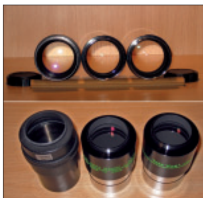
Abb. 7: Reducer und Flattener. Von links nach rechts: Intes 0,75x, Tele Vue 0,8x Flattener L und Tele Vue 0,8x Flattener S.
