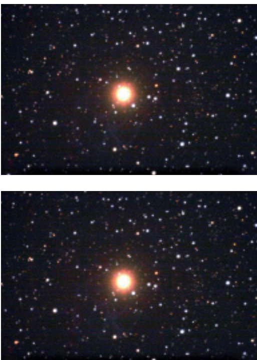
Abb. 9: Eta Geminorum, ein Stern dritter Größenklasse. Oben: Aufnahme mit TeleVue 0,8x Flattener L, unten: Intes 0,75x. Aufgrund der schlechteren Vergütung erzeugt der Intes 0,75x-Reducer einen Lichttring um den Stern. Beide Reducer zeigen zudem ein schwaches bläuliches Geisterbild der Korrektionsplatte. Kamera: modifizierte Canon EOS 20D.
