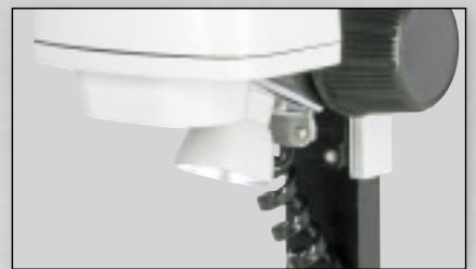
Netzunabhängige Beleuchtung Battery-supplied light
